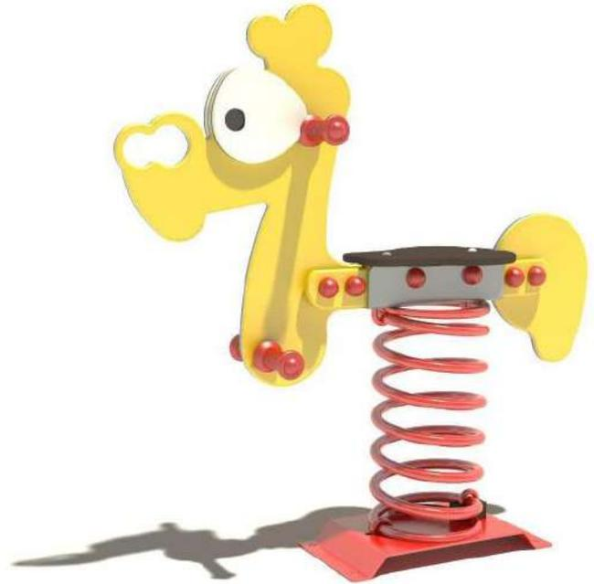
El muelle es de acero 35SCD6. La superficie se trata después con granalla pretensada con capas de preparación de zinc y 2 capas de polvo de poliéster de 100 micrones. La pieza de fijación en poliamida cargada garantiza una longevidad y una seguridad excepcional al sistema. Las manetas y reposapiés son de plástico poliamida muy resistente. La tornillería en acero inoxidable está protegida por cápsulas anti-vandalismo en poliamida.
