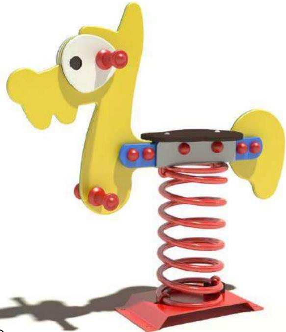
El muelle es de acero 35SCD6. La superficie se trata después con granalla pretensada con capas de preparación de zinc y 2 capas de polvo de poliéster de 100 micrones. La pieza de fijación en poliamida cargada garantiza una longevidad y una seguridad excepcional al sistema. Las manetas y reposapiés son de plástico poliamida muy resistente. La tornillería en acero inoxidable está protegida por cápsulas anti-vandalismo en poliamida.
