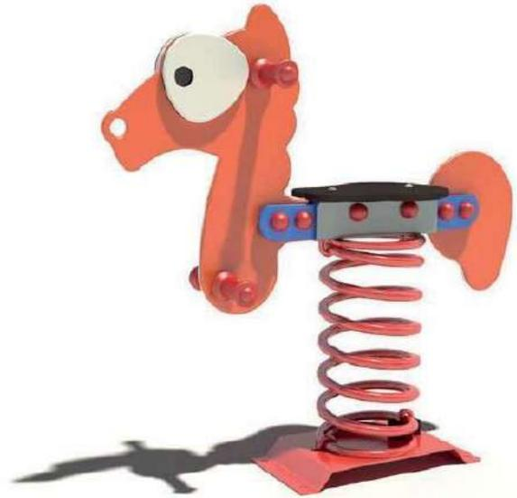
El muelle es de acero diámetro de 20 mm. La superficie se trata después con granalla pretensada con capas de preparación de zinc y 2 capas de polvo de poliéster de 100 micrones. La pieza de fijación en poliamida cargada garantiza una longevidad y una seguridad excepcional al sistema. Las manetas y reposapiés son de plástico poliamida muy resistente. La tornillería en acero inoxidable está protegida por cápsulas anti-vandalismo en poliamida.
